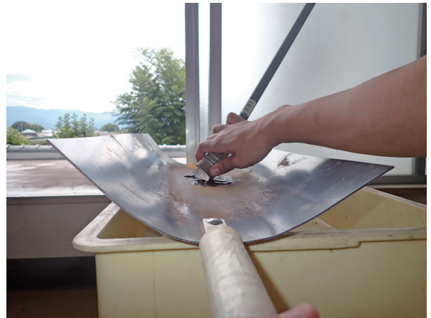
図10. 鉄樋を回転させない場合の水晶玉と研磨道具の位置関係
